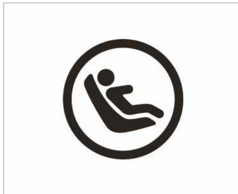
Simbolo per il fissaggio di un sistema di ritenuta per bambini ISOFIX
