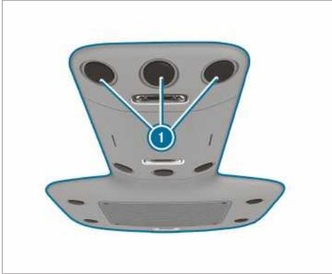
В автомобилях с кондиционером в задней части салона регулируемые вентиляционные дефлекторы встроены в воздушный канал крыши.
