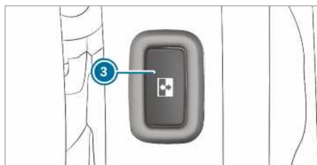
Tasto della porta scorrevole nella zona di accesso (montante centrale)
