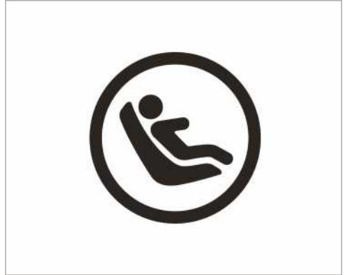
Simbolo per il fissaggio di un sistema di ritenuta per bambini ISOFIX
