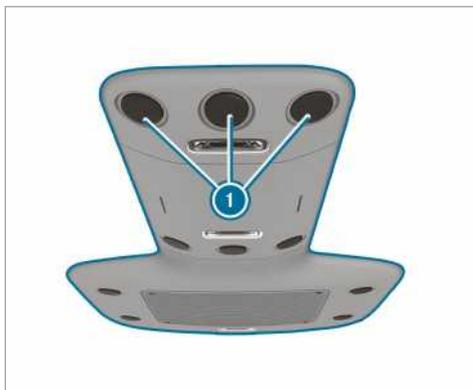
Em veículos com ar condicionado traseiro, estão integrados difusores de ventilação reguláveis no canal de ar do teto.
