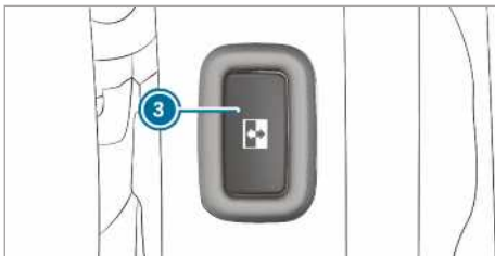
Tecla de la puerta corredera situada en el umbral de la puerta (montante B)
