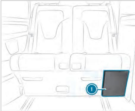
La touche de remise à zéro se trouve sous la banquette-couchette du côté du siège du conducteur au niveau de la trappe de chargement d'objets longs ❶.
