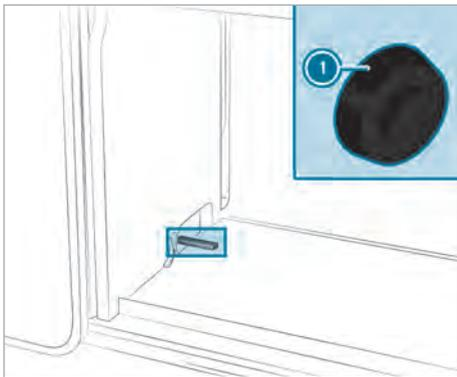
La touche d'activation de la commande de secours ❶ se trouve dans le placard situé sous le réchaud à gaz, dans l'évidement pour la vanne d'arrêt du réservoir des eaux grises (paroi latérale gauche).
