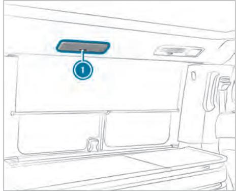
Les lampes LED sont montées sur les 2 côtés véhicule, entre les montants B et C, dans le cadre de toit. Les 2 lampes LED sont enclenchables automatiquement et manuellement. Par ailleurs, les lampes LED sont à luminosité variable en continu.
