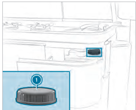
Deksel van de reinigungsopening van het grijswaterreservoir
